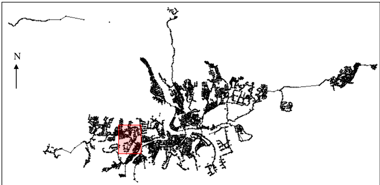
Figur 3. Datamängd bestående av 11267 noder samt 9187 ledningar uppritat i SWMM. Den mindre kvadraten i figuren visar ledningsnätet som används för att bygga upp en modell.
