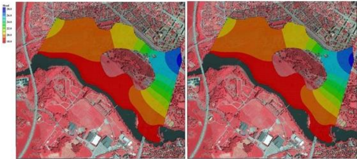
Figur J1 Grundvattennivåer vid ansats av minimal hydraulisk konduktivitet för silt, 10^{-9} m/s, till vänster, samt maximal hydraulisk konduktivitet för silt, 10^{-5} m/s, ses till höger med underliggande GSD–Ortofoto och GSD–Ortofoto25. © Lantmäteriet
