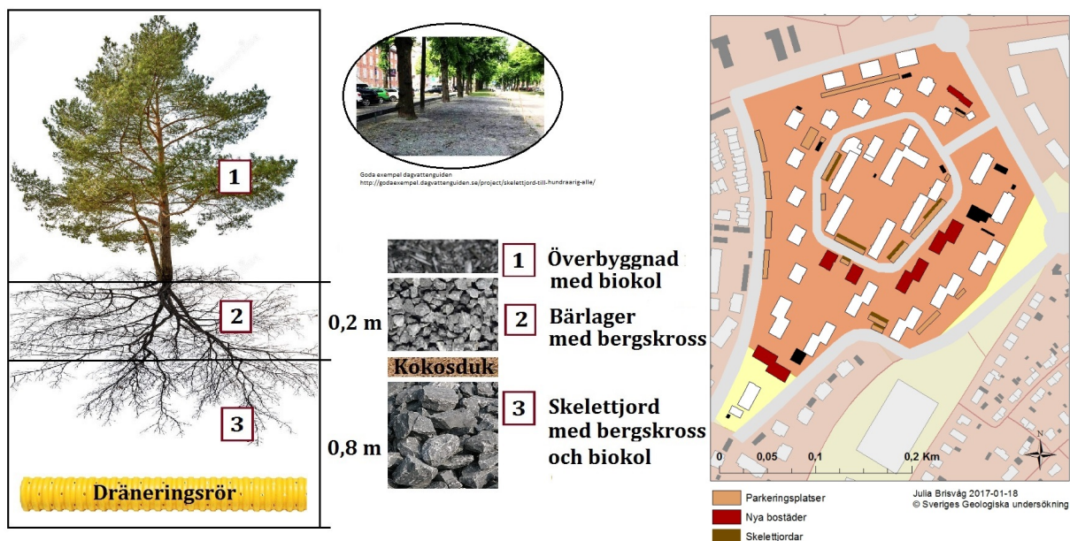
Figur 4.2.6: Skiss av konstruktion för alternativ Skelett (vänster) och karta över placering av system på Studentvägen (höger). För respektive lager i skelettjorden presenteras dimensioner i meter. För kartan illustreras skelettjordar som brunt och nya parkeringsplatser som orange.
