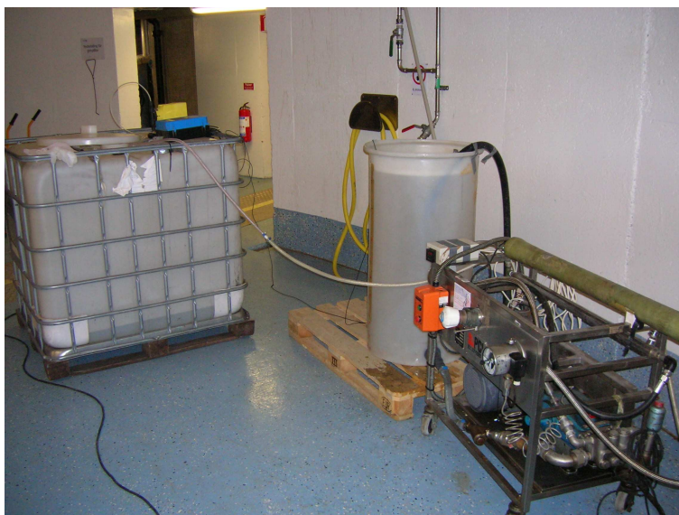
Figur 6: RO-anläggningen under uppkoncentrering med koncentrattank i mitten och permeattank till vänster. RO-enheten till höger.
