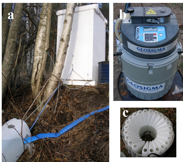
Figur 11 Provtagning av brunnsvattnet från ett uppsamlingskärl och en värmeisolerad kåpa där provtagaren var placerad (a). Automatprovtagare (b) med 24 stycken flaskor (c).
