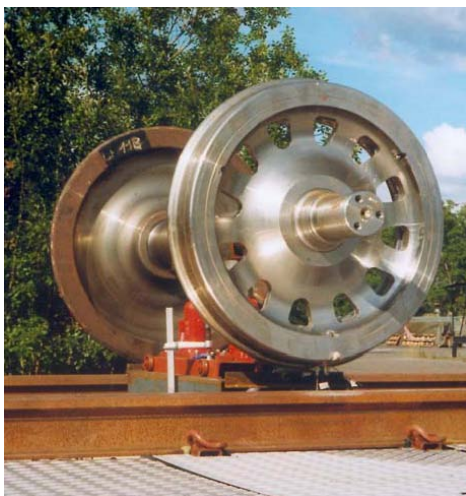
Figur 15. Exempel på hjulboggi med perforerat hjul (Åbom, 2009).
