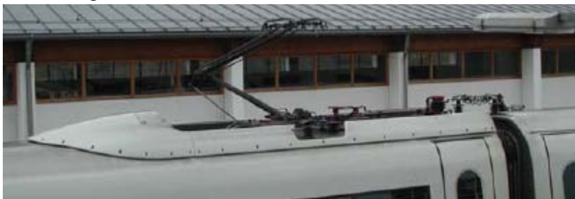
Figur 38. Strömavtagare och kopplingen mellan vagnarna för en ICE-3
