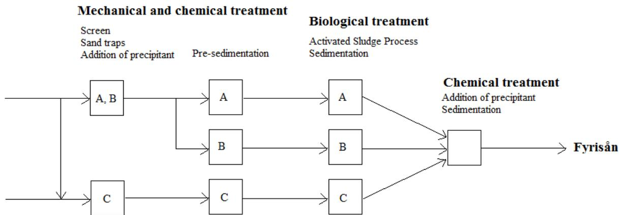
Figure 1. Principle sketch of the treatment train at Kungsängsverket. Adapted from (Uppsala Vatten och Avfall AB, 2015). Used with permission from Uppsala Vatten och Avfall.
