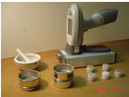
Fig. 5 Niton XLt 700 med mortel, siktar, provhållare och provkoppar.
