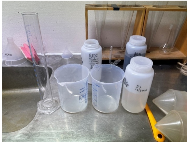
Figur 12: Mätglas och literbägare som användes vid förtjockning.
