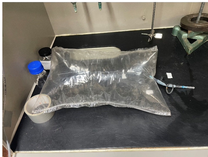
Figur 11: Gasballongen som användes för att tryckutjämna vid matning.
