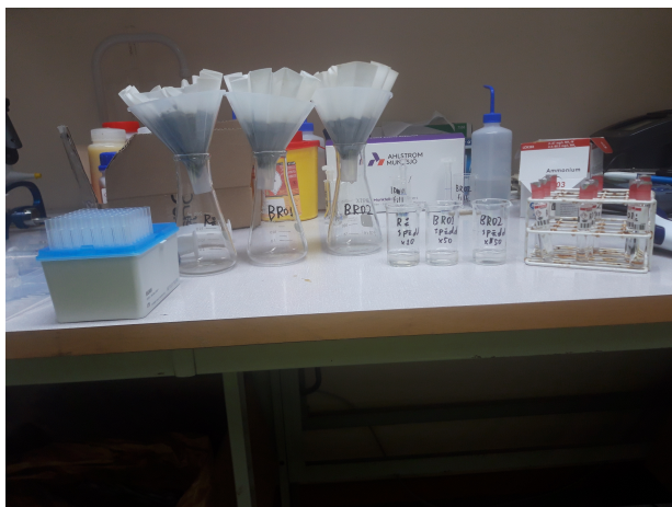
Figur 13: Uppställning för veckfiltrering utan sprutor.
