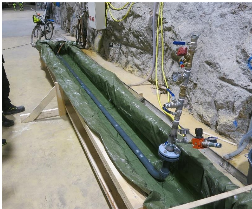
Figur 25 Doserrampen med dimensionen DN50 placerad i testbassängen med djupet 0,4 m.
