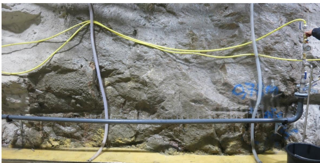
Figur 10 Fullskalig prototyp av doserrampen med rördimensionen DN50.
