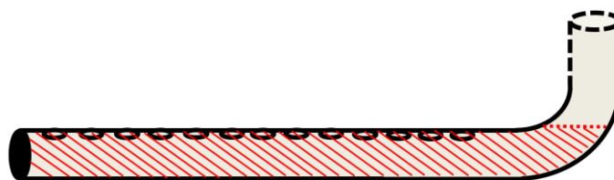
Figur 15 Illustration av fyllkropparnas fyllnadsgrad längs den perforerade rördelen som anges inom det röstreckade området.
