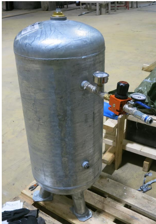
Figur 16 Mätning av tryckluftsflödet med hjälp av ett tryckkärl.
