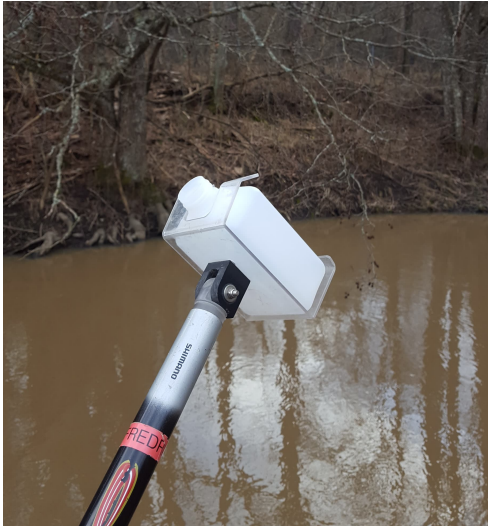
(a) En provtagningsflaska med tillhörande hållare för att kunna ta manuella stickprov i ån. (Jonsson 2020d)
