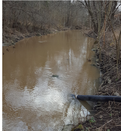
(b) Det svarta röret som går ner i vattnet innehåller den sensor som mäter turbiditeten. (Jonsson 2020e)
