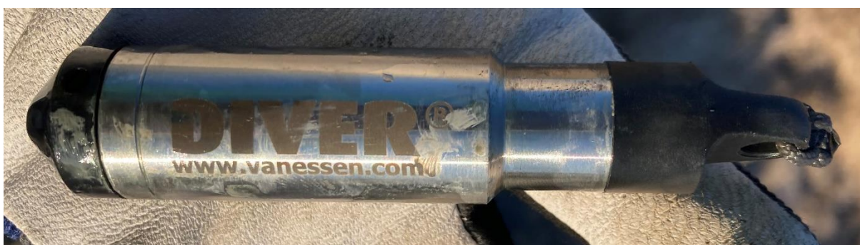
Figur 2: En av tryckgivarna som användes under provpumpningen.
