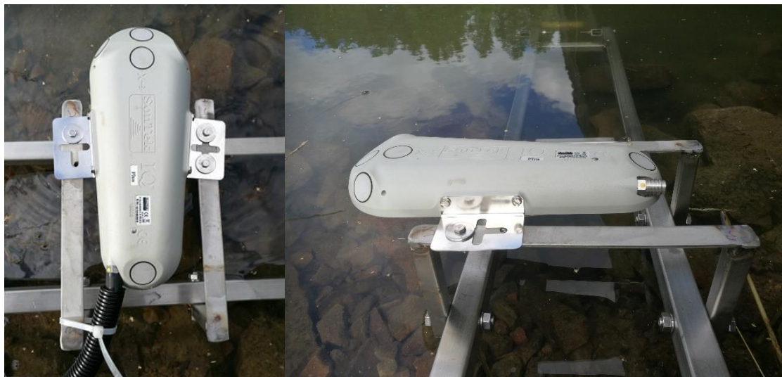
Figur 9. Mätaren SonTek-IQ Plus monterad på ställningen.
