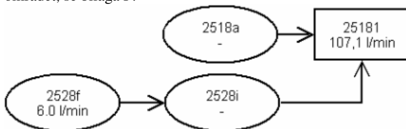
Figur 4.5. Flödesschema, uppsamlingsområde 25181. Ellipserna visar dränmätrarna ute i systemet och rektangeln dränmätaren i pumpstationen.
