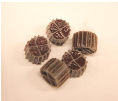
Figur 2. Bärarmaterial av typen Kaldnes K1. Bärarnas fyra zoner är fyllda av biomassa.
