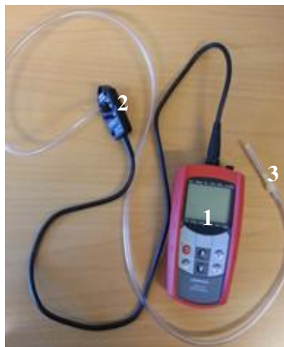
Figur 5. Tryckmätare (1) ihopkopplad med trycksensor (2). Från trycksensorn går en PVC-slang till en nål (3).
