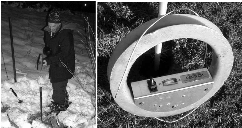
Figur 5.3 (a) Sonderingsstål slås ned i marken med slägga. Personen på bilden är Alf Olsson. Foto Ida Franklin.
