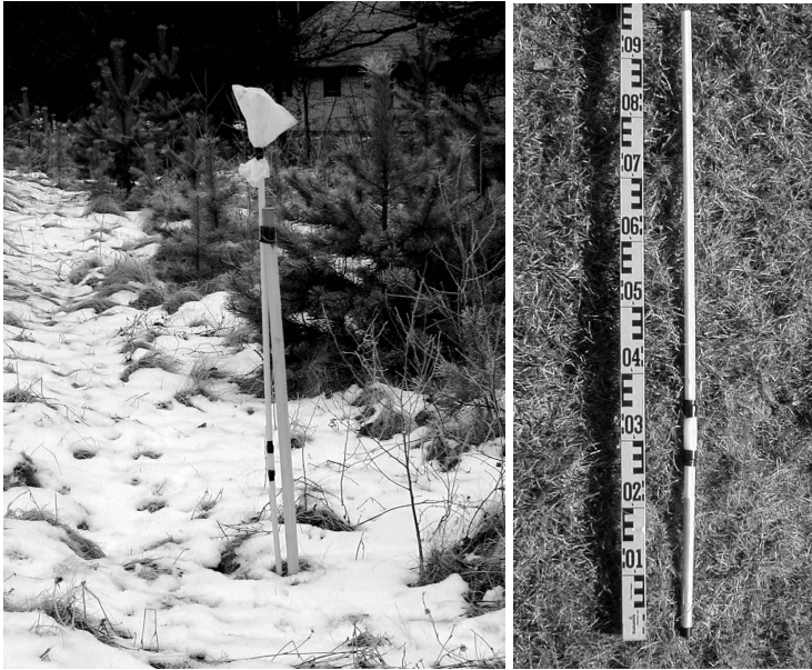
Figur 5.2 (a) Grundvattenrören stadgas med en stakkäpp och skyddas från nederbörd med en huva. Här grundvattenrör 80 vid porten i Ulvåker.
