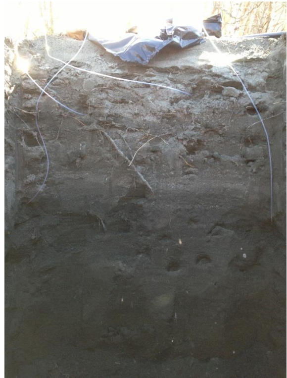
Figur E1. Provgrop 1401. De gula och vita graderingarna på tumstocken i den vänstra bilden svarar mot 0,10 meter vardera. Den högra bilden visar lysimetrarnas placering.
