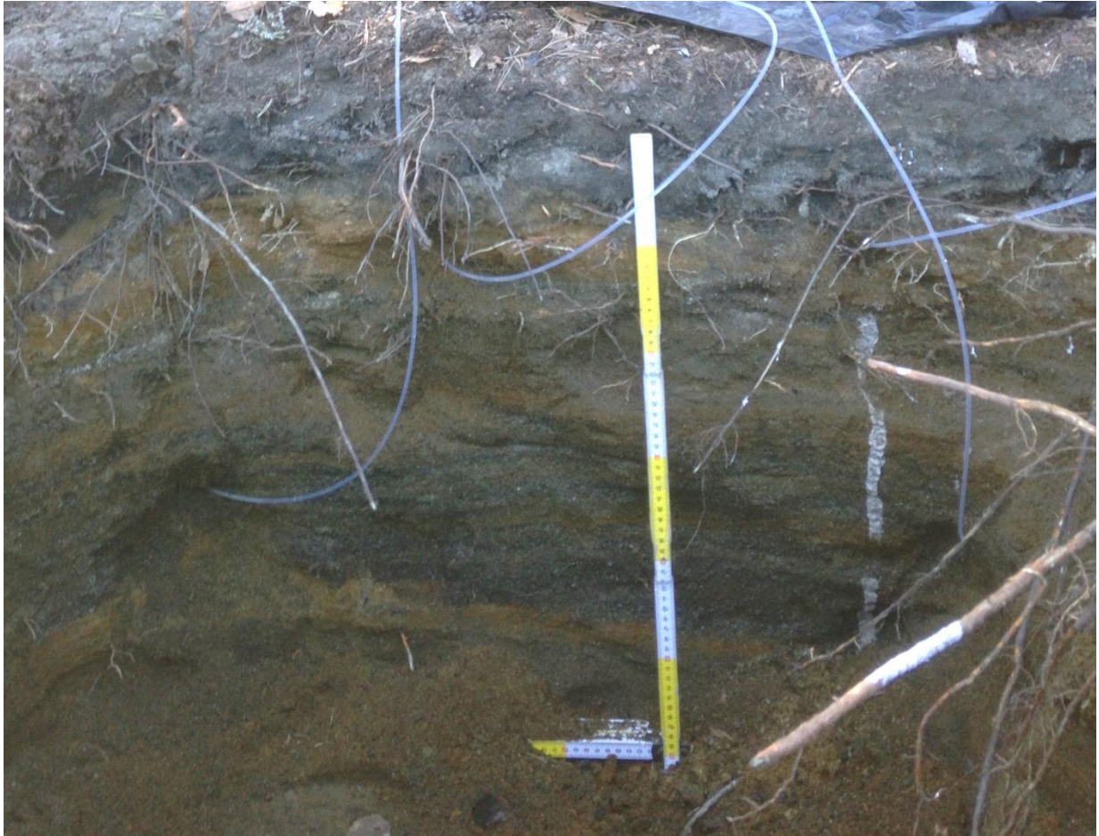
Figur E5. Provgrop 1410 och dess placering av lysimetrar. De gula och vita graderingarna på tumstocken svarar mot 0,10 m vardera.
