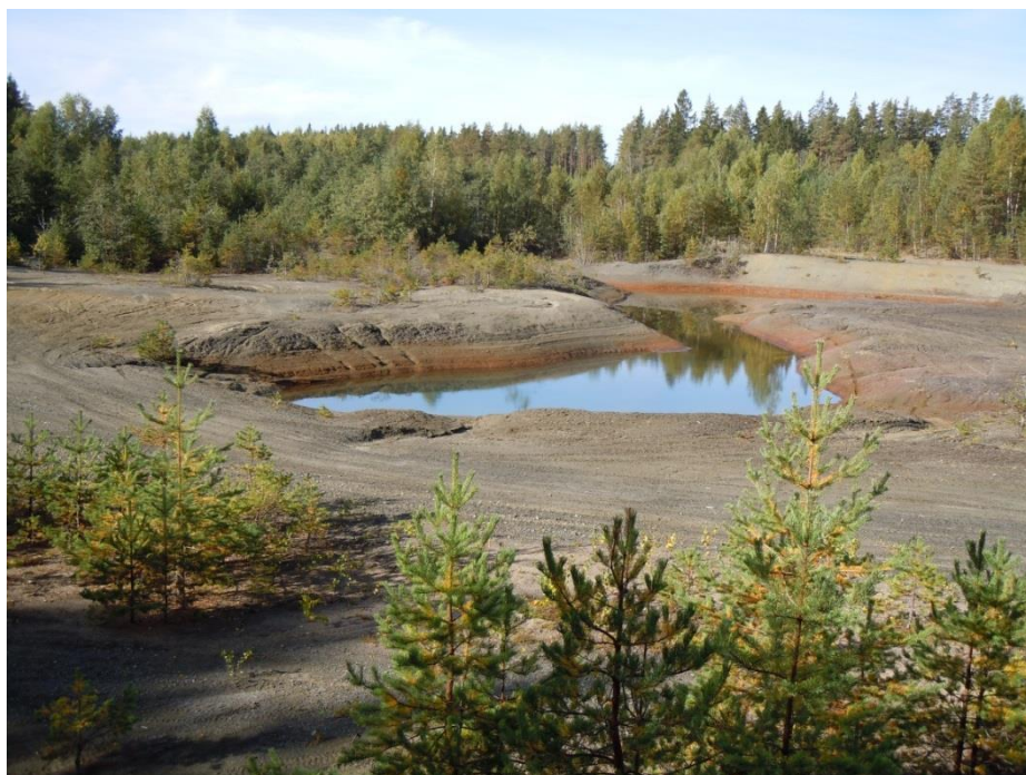
Figur 3. En del av det västra undersökningsområdet och dess vattensamling. Vid vattensamlingens kant ses tecken på vad som troligen är järnoxidutfällningar.
