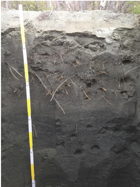
Figur E1. Provgrop 1401. De gula och vita graderingarna på tumstocken i den vänstra bilden svarar mot 0,10 meter vardera. Den högra bilden visar lysimetrarnas placering.
