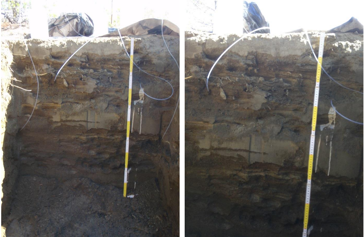
Figur E3. Provgrop 1403 och placering av dess lysimetrar. De gula och vita graderingarna på tumstocken svarar mot 0,10 m vardera.
