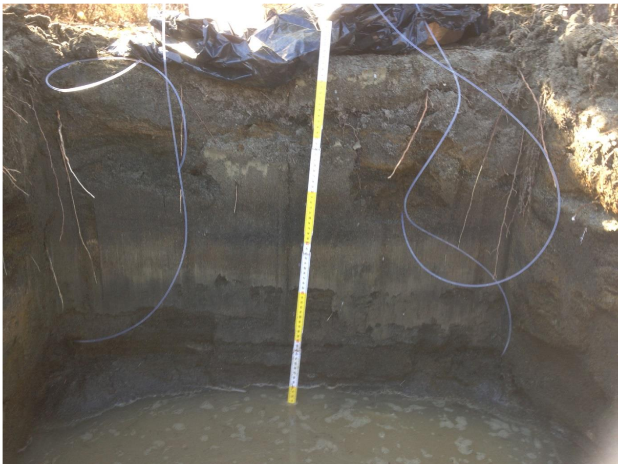
Figur E4. Provgrop 1404 och dess placering av lysimetrar. De två nedre provtagarna var vid installationstillfället belägna under grundvattenytan i bildens nederkant. De gula och vita graderingarna på tumstocken svarar mot 0,10 m vardera.
