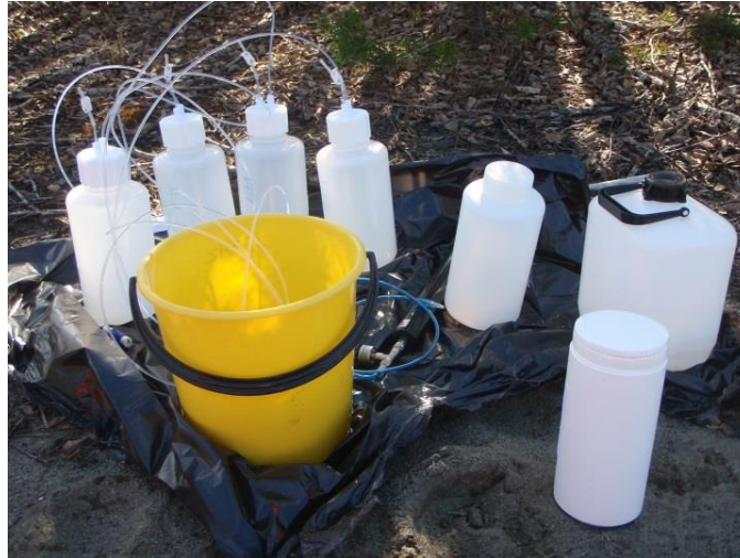
Figur 14. Täckning av lysimetrarnas yta med kvartsslurry. Undertryck pumpades i de uppsamlingsflaskor som var sammankopplade med lysimetrarna, varefter de lämnades att suga kvartsslurry från en hink under ca 20 min.
