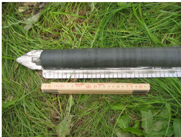
Figur B2 Foton tagna vid provtagning på Kungsängen, Uppsala. Första bilden visar provtagningsutrustning i form av ryssborr, den andra visar den varviga leran som tagits upp ur diket.
