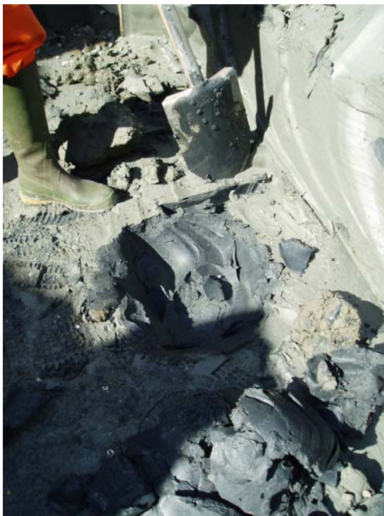
Figur B1 Foton tagna vid provtagning på kvarteret Gerd, Uppsala. Första bilden visar provtagning av svartstrimmig lera i hisschakt (punkt A1), den andra visar tydlig sprickbildning vid provtagningspunkt B1.
