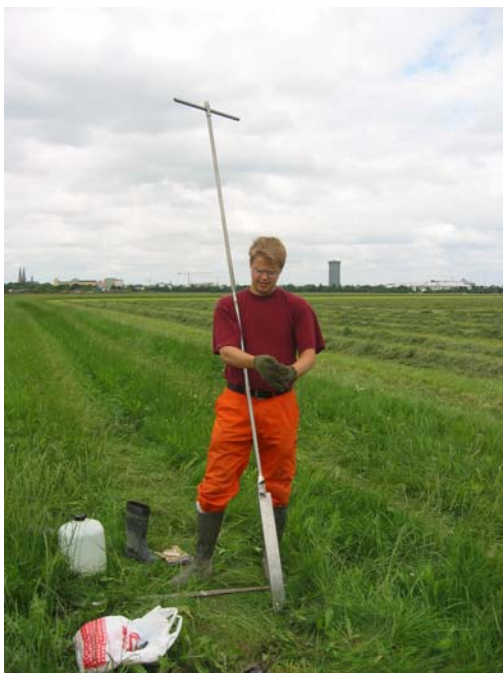
Figur B2 Foton tagna vid provtagning på Kungsängen, Uppsala. Första bilden visar provtagningsutrustning i form av ryssborr, den andra visar den varviga leran som tagits upp ur diket.
