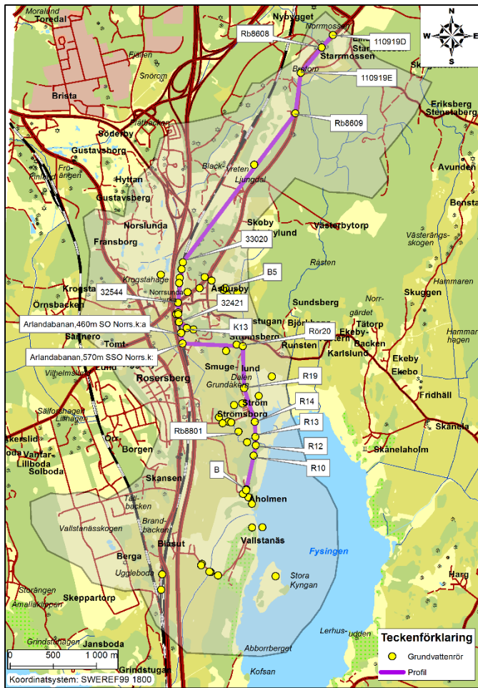
Figur 14. Grundvattennivåerna undersöktes i profil för modellområdet för att få en inblick i hur ytans lutning ser ut i genomskärning (den lila linjen).
