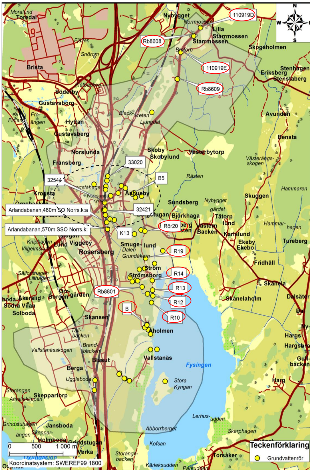
Figur 4. Grundvattenrören är distribuerade främst längs med grusåsen. De rör som markerats med namn användes vid kalibreringen av stationära förhållanden. Egna grundvattenmätningar utfördes i de rör som markerats med en röd ring runt rörets namn. Den svarta, streckade linjen visar stalpets ungefärliga läge i modellområdet. (© Sveriges Geologiska Undersökning).
