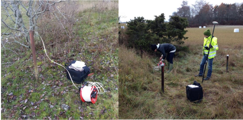
Figur 5. Mätning av grundvattenytan i observationsrören och inmätning av rören.
