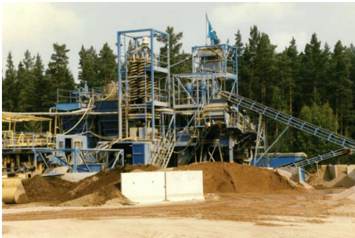
Figur 6. Mobil jordtvättanläggning, Foto: Jan Andersson, 1997. Figur lånad från SWECO, med tillstånd.
