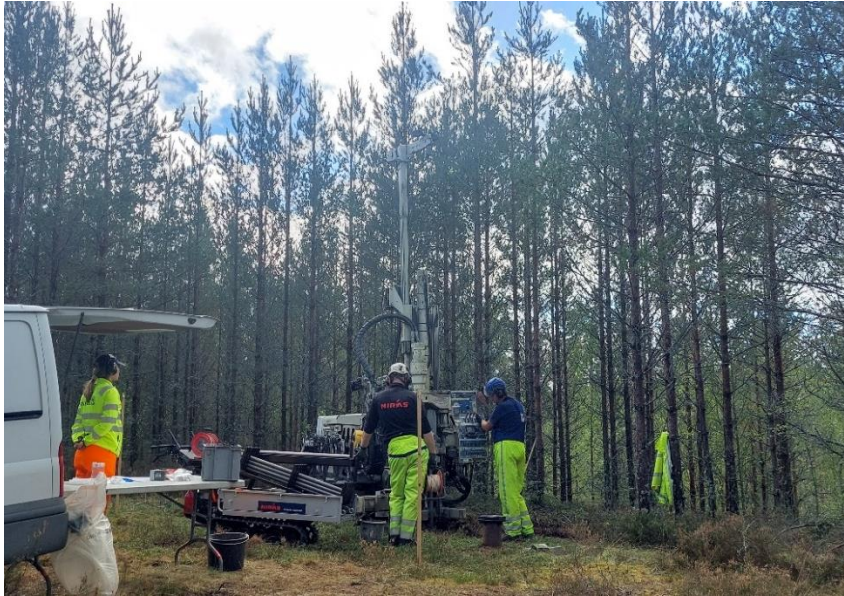
Figur 9. Geoprobe utrustad för dynamisk grundvattenprovtagning.
