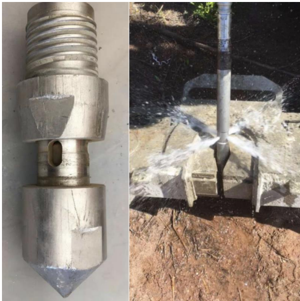
Figur 12. 2.21" Geoprobe retractable single port injection tip , Bild lånad med tillstånd från Sweco, 2022.
