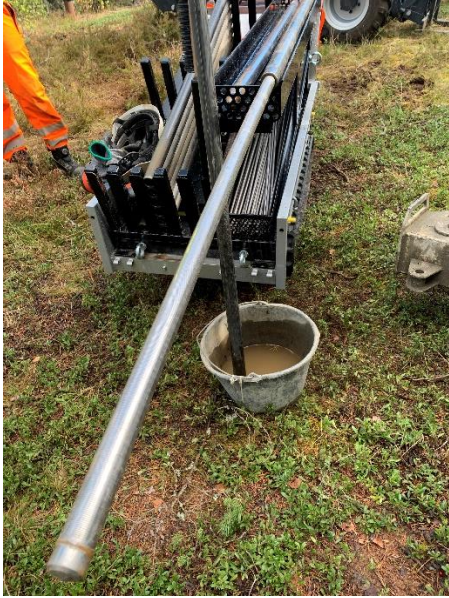
Figur 10. Geoprobens borrhets för dynamisk grundvattenprovtagning. Filtret är 1 m långt.
