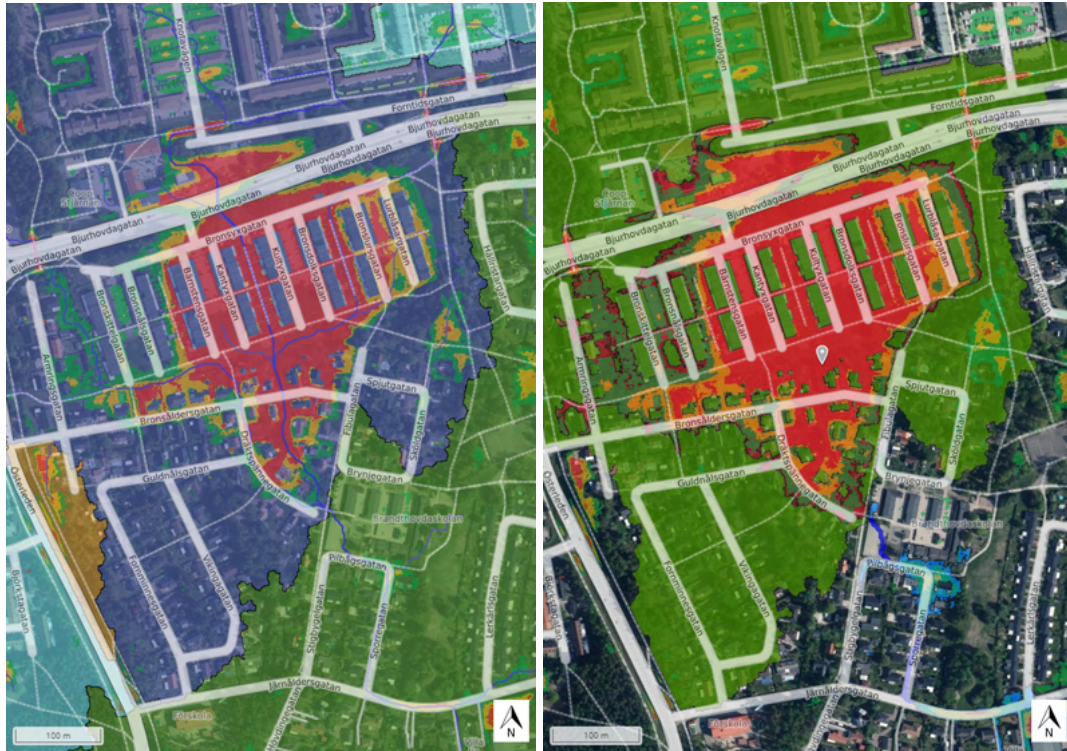
Figur 10: Område 1 med med översvämningar av 55 mm regn (figur till vänster) och 57 mm regn (figur till höger). Figuren till vänster visar rinnvägar som kommer från områden som är 1 ha eller större i är markerad som blåa streck. Avrinningsområdena i figuren är markerade i grönt, gult, blått och violett. Område 1 ligger i det violetta avrinningsområdet. I den högra figuren visas lågpunkts tröskelvärde. Tröskelvärdet för att lågpunkten ska bli full är 57 mm regn och en rinnväg (markerad i blått) skapas som leder till recipienten. Skala 1:2900, SCALGO Live (2023).
