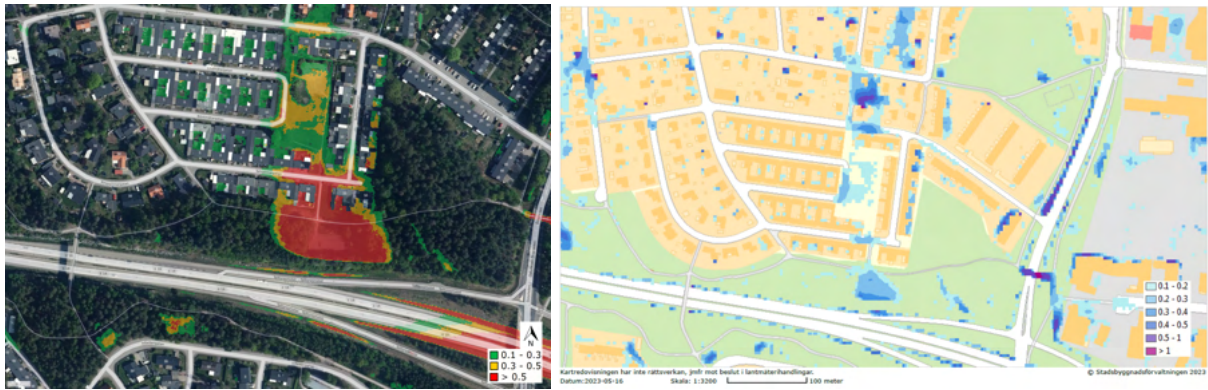
Figur 14: Jämförelse av lågpunktskartering (vänster) och skyfallskarteringen med markavrinning samt ledningsnät (höger) över område 2. Båda karteringar visar återkomsttiden 100 år. Skala på västra karteringen är 1:1700. SCALGO Live (2023) och DHI (2017).
