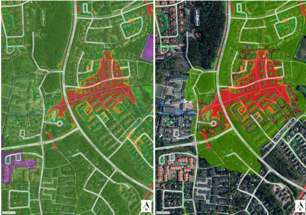
Figur 16: Område 3 med med översvämningar av 55 mm regn (figur till vänster) och 26 mm regn (figur till höger). Figuren till vänster visar rinnvägar som kommer från områden som är 1 ha eller större i är markerad som blåa streck. Avrinningsområdena i figuren är markerade i grönt och violett. Område 3 ligger i det gröna avrinningsområdet. I den högra figuren visas lågpunktens tröskelvärde. Tröskelvärde för att lågpunkten ska bli full är 26 mm regn och en rinnväg (markerad i blått) skapas som leder till recipienten. Skala 1:2900, SCALGO Live (2023).
