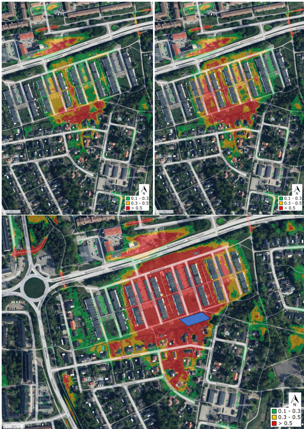
Figur 9: Lågpunktskartering över område 1 med översvämningar från 10-, 20- och 100-årsregn. Varaktigheten är 60 minuter. Vattendjup mellan 0,1-0,3 meter är färgat i grönt, vattendjup mellan 0,3-0,5 meter är färgat i gult och vatten över 0,5 meter färgades rött. Blå romb markerar den förslagna platsen för en magasineringssyta. Skala 1:2200 för 10- och 20-årsregnen, 1:2600 för 100-årsregnet. SCALGO Live (2023).
