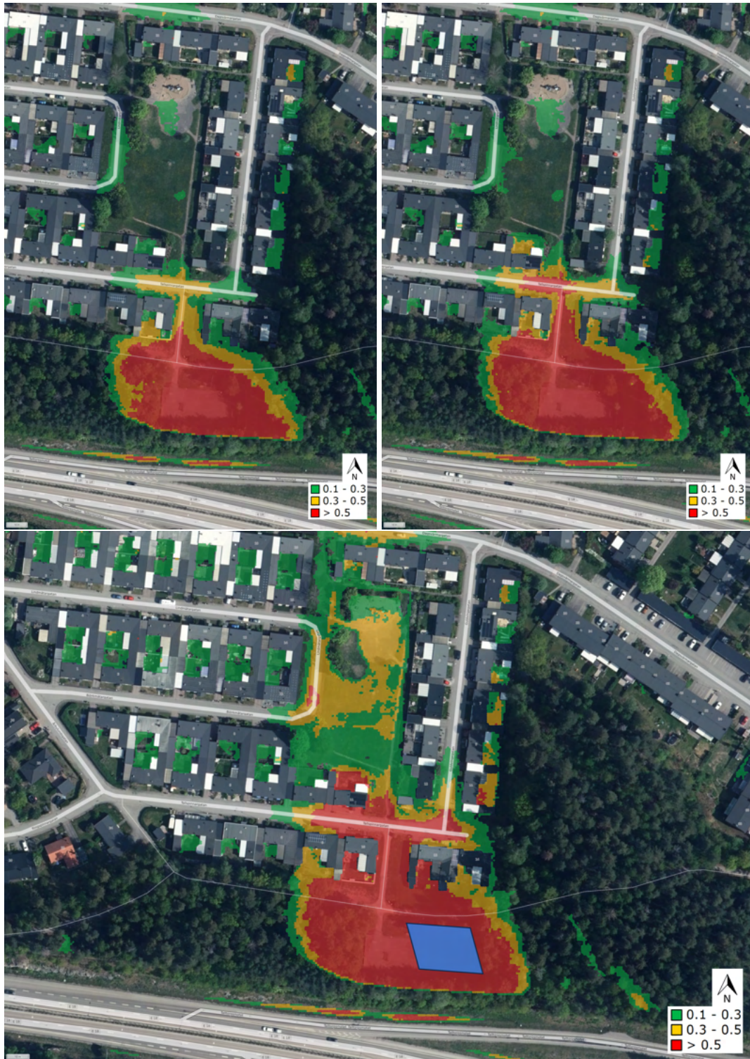
Figur 12: Lågpunktskartering över område 2 med översvämningar från 10-, 20- och 100-årsregn. Varaktigheten är 60 minuter. Vattendjup mellan 0,1-0,3 meter är färgat i grönt, vattendjup mellan 0,3-0,5 meter är färgat i gult och vatten över 0,5 meter färgades rött. Blå romb markerar den förslagna platsen för en magasineringsyta i karteringen för 100-årsregn. Skala 1:920 för 10- och 20-årsregnen, 1:2000 för 100-årsregnet. SCALGO Live (2023).
