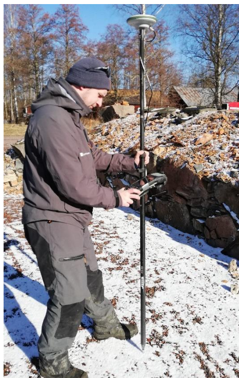
Figur 5. Foto på GPS som användes för inmätning
