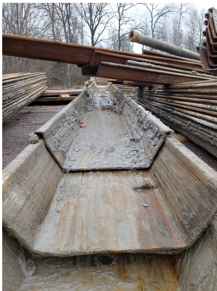
Figur 2: Använd och otvättad profilerad stålsPont
