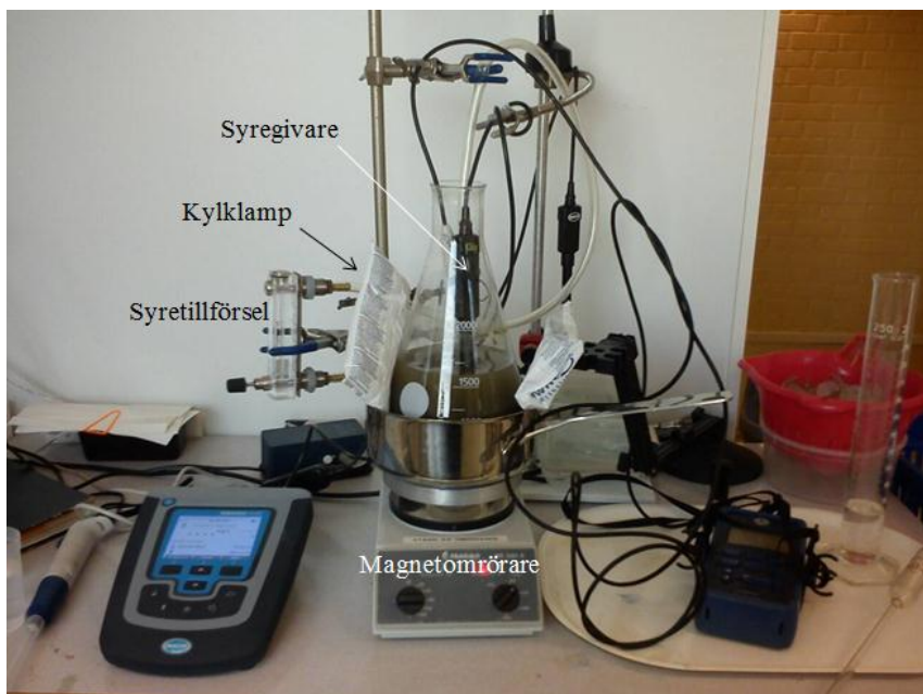
Figur 14. Försöksuppställning vid det andra fosforsläpps- och fosforupptagsförsöket vid Duvbackens ARV, 28 februari 2013.
