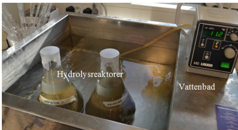
Figur 15. Försöksuppställning vid det andra hydrolysförsöket vid Duvbackens ARV, 11-12 mars 2013.
