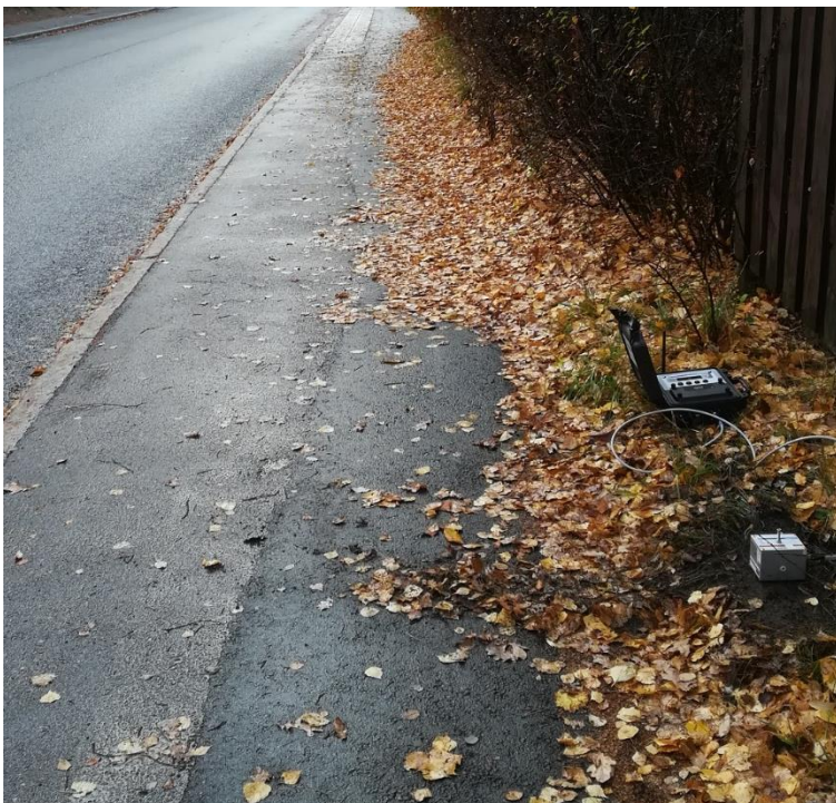
Figur 10. Ett exempel på en mätpunkt vilken definieras som referenspunkt (mätpunkt 1). Mätaren är placerad på ett jordspett i marken och kopplad till en master.
