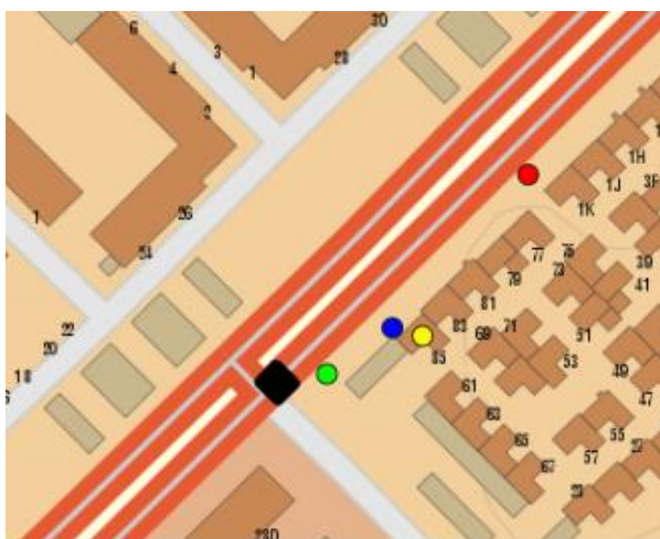
Figur 7. Placering av mätpunkt 1–4 vid mätplats C. Mätpunkt 1, referenspunkt, har färgen röd. Mätpunkt 2, vid busskudde, har färgen grön. Mätpunkt 3, vid husvägg, har färgen blå. Mätpunkt 4, inomhus, har färgen gul. Två parallella busskuddar är markerade med en svart rektangel. Ursprunglig karta från Lantmäteriet (2018).
