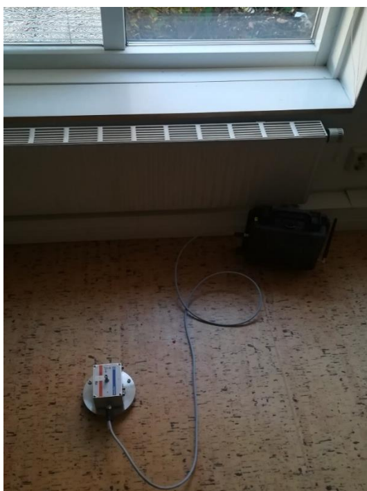
Figur 13. Ett exempel på en mätpunkt vilken definieras som inomhus (mätpunkt 4). Mätaren är placerad på en platta, vilken är placerad på golvet, och kopplad till en master.
