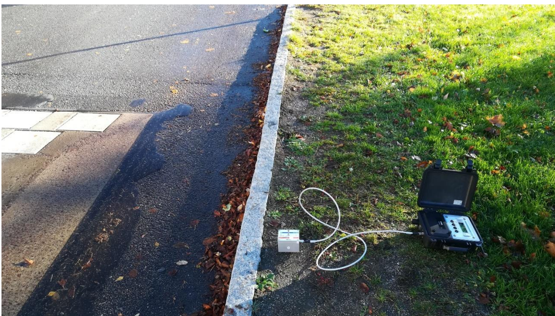
Figur 11. Ett exempel på en mätpunkt vilken definieras som placerad vid busskudde (mätpunkt 2 eller 2a). Mätaren är placerad på ett jordspett i marken och kopplad till en master.
