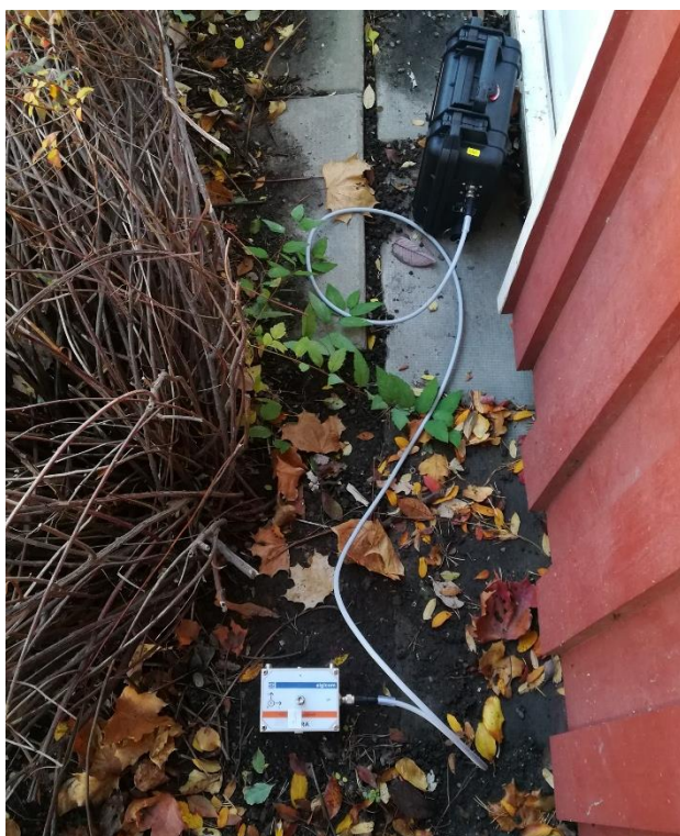
Figur 12. Ett exempel på en mätpunkt vilken definieras som placerad vid husvägg (mätpunkt 3). Mätaren är placerad på ett jordspett i marken och kopplad till en master.
