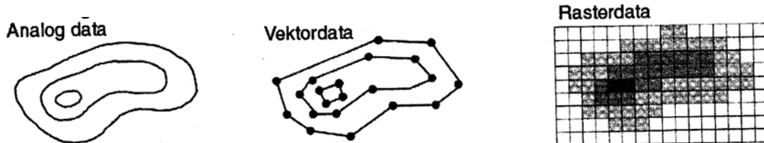
Figur 2.1. Jämförelse mellan hur objekt beskrivs i vektorformat och i rasterformat. (Axelsson, 2001, sid. 11).
