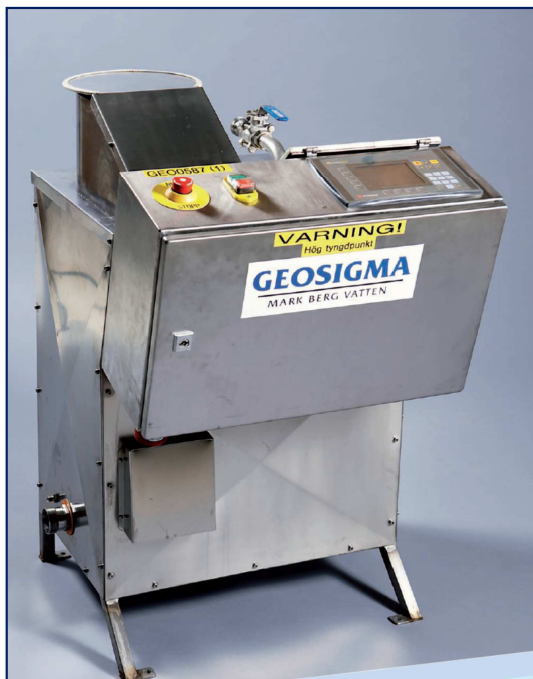
Figur 6. Geosigmas utrustning för injektionstester i borrhål med konstant tryck, WIC. © Geosigma
