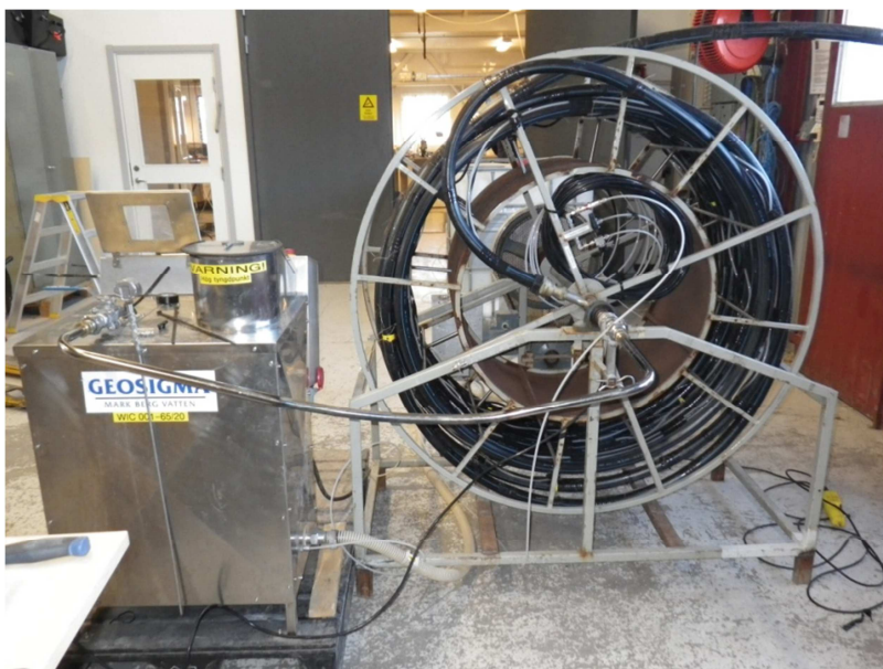
Figur 7. WIC och PEM-slang ihopkopplade via rörgång. Bakom slangvindan skymtas vattentanken.
