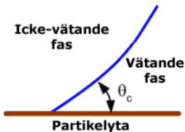
Figur 6 – Vätningsegenskaper mellan två vätskor i kontakt med partikelyta. Vinkeln \theta_C avgör vilken vätska som är den vätande (API, 2007).
