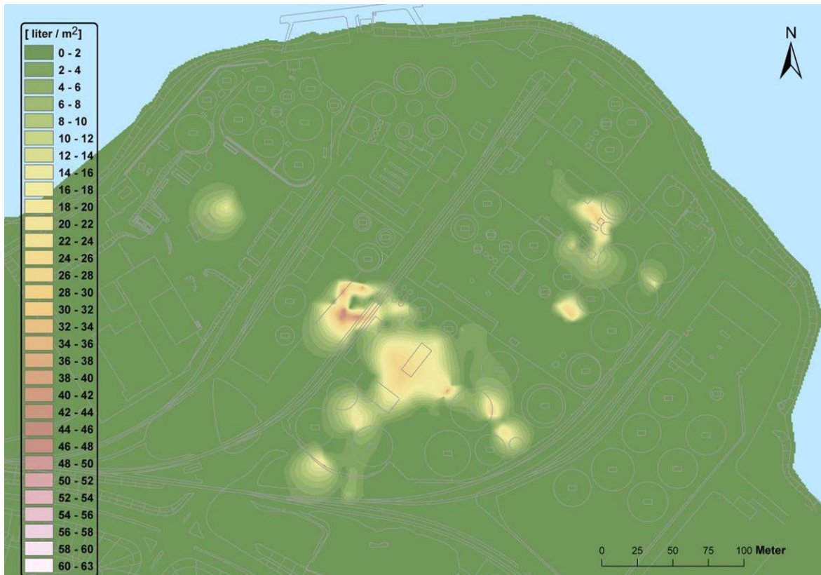
Figur 14 - Uppskattning av mobil olja inom Sundsvalls oljehamn sommaren 2004 innan saneringen inleddes. Kartan illustrerar utbredningen av de 162 kubikmeter mobil olja i fri fas som uppskattats ha funnits. Kartan är framtagen i enlighet med avsnitt 4.3.2.
