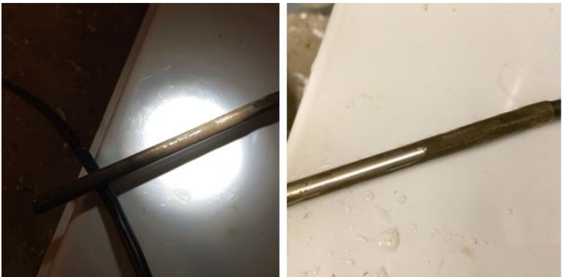
Figur B. 6 Grönbrunt slam på temperaturgivaren till logger
