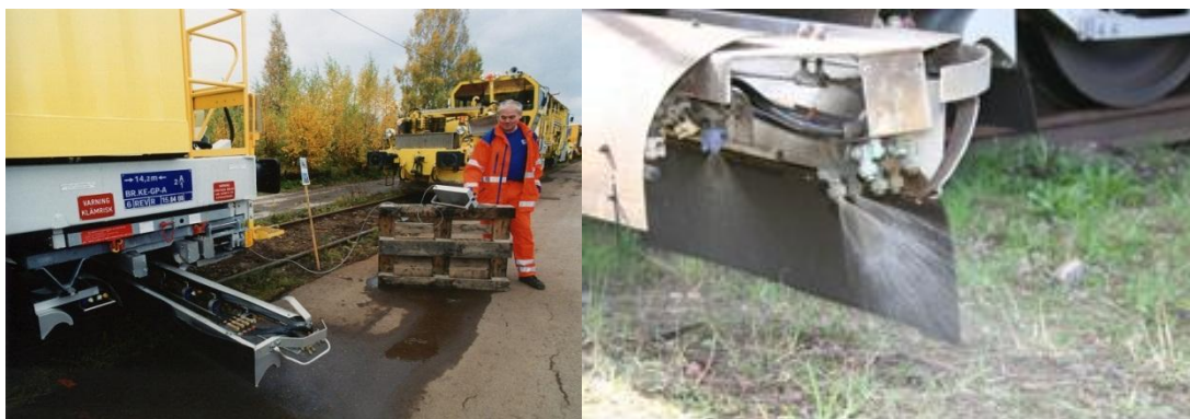
Figur 2-3. Besprutningsanordning som sitter bak på ogräståget. Den så kallade ogräsrampen är designad så att bekämpningsmedlet pressas nedåt i marken för att minimera vindavdrift (Trafikverket, 2012a).
