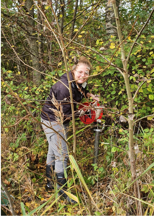
Figur 16. Mätning av grundvattennivå med ljuslod i grundvattenrör 6904.
