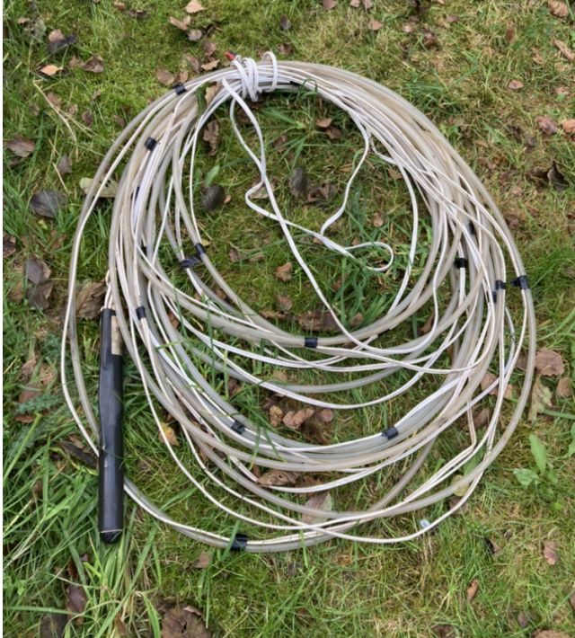
Figur 18. Dränkbar pump (svart stav) som kan sänkas ner i grundvattenröret.
