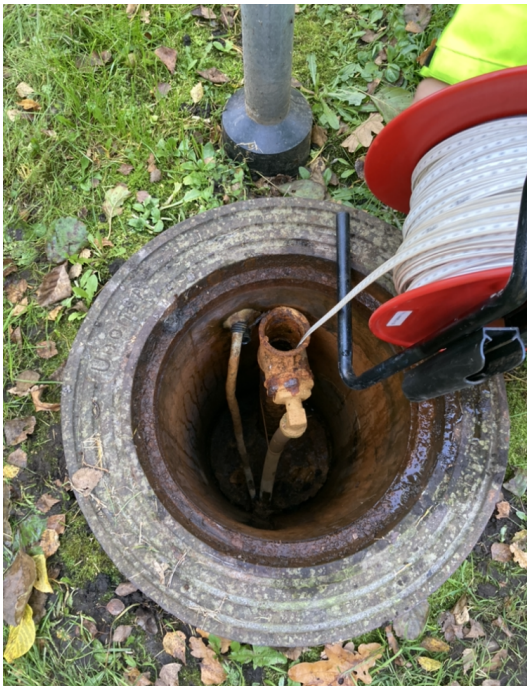
Figur 15. Ljuslod på måttband sänks ner i grundvattenrör 7305 för att mäta djupet till grundvattennivå inför funktionstest. Ljuslodet piper då det når vattenytan och djupet från rörets kant till vattenytan kan avläsas på måttbandet.
