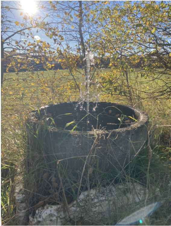
Figur 22. Det artesisiska grundvattenröret 9202 då kranen är öppen. Grundvattnet självrinner ur röret och dess tryckyta befinner sig ovanför marknivån.
