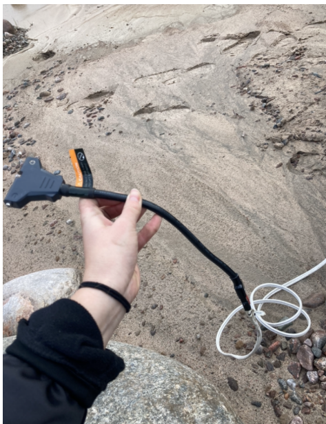
Figur 19. Kopplingsladd mellan pumpens strömsladd och batteri.
