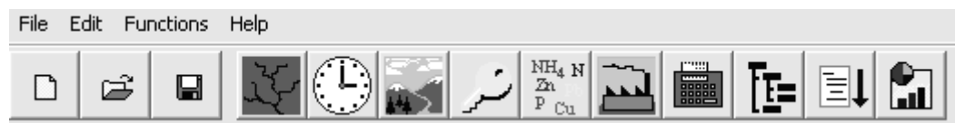
Figur 9. Meny i WinHSPF. Från vänster till höger är valen att skapa nytt projekt, öppna projekt, spara projekt, redigera det hydrologiska nätverket, ställa in tid och meteorologisk indatafil, redigera markanvändningsarealer, välj aktiva moduler, redigera kemikalier, redigera punktkällor, modifiera parametervärden, definiera utdata, köra programmet, se resultatet i GenSen.
