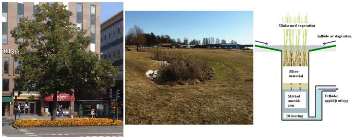
Figur 9. Till vänster: Växtbädd på Vasagatan i Stockholm. En lind och plantering av sommarblomster (bild av Örjan Stål, 2009 med tillstånd). Mitten: Biofilter i form av ett långsträckt bevuxet dike på Öster Mälarstrand i Västerås (bild av Emma Matschoss-Falck, 2013). Till höger: Illustration av principskiss för ett mer kompakt biofilter med vattenlås (bild efter Luleå tekniska universitet, 2012).
