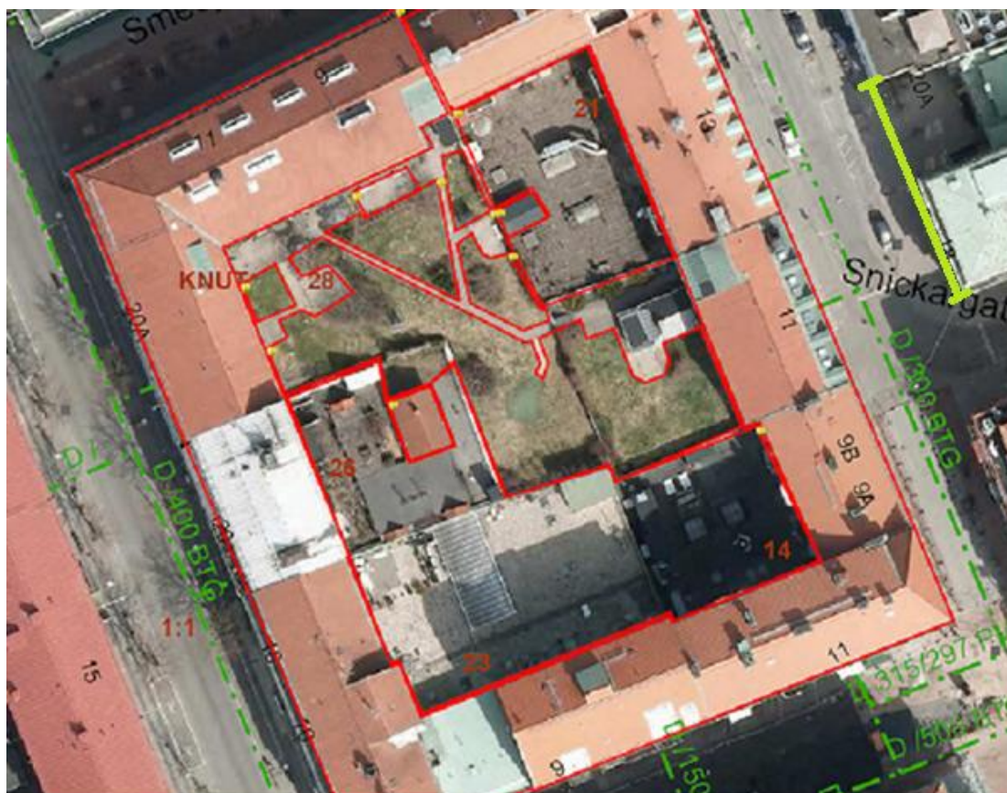
Figur 19. Kvarteret Knut i Västerås. De röda linjerna visar hur de olika områdena (takyta, annan hårdgjord yta och gräsyta) avskilts för beräkning av areorna. Den gula linjen visar den uppmätta referenssträckan Posthuset fram till restaurangen Spicy hot (bild efter Mälarenergi, 2013).
