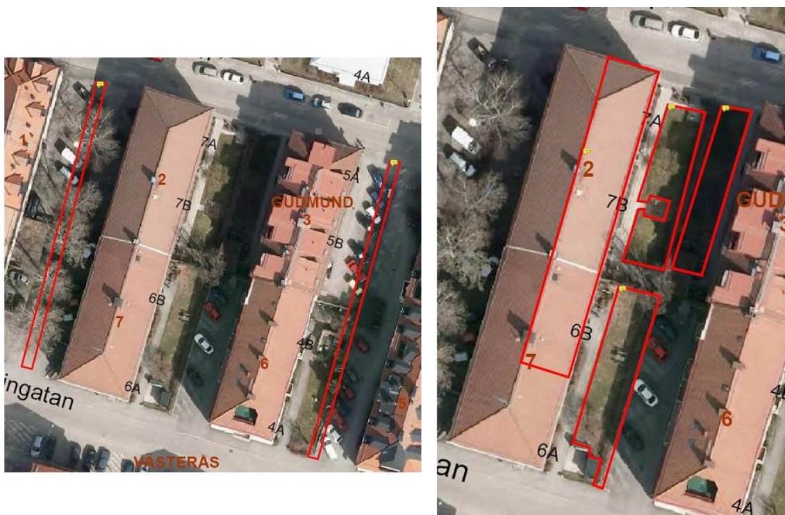
Figur 31. Kvarteret Gudmund. Till vänster: Markerade ytor kan användas som svackdike. Till höger: Markerade grösytor kan användas för infiltrering av dagvatten från den markerade takytan på hus två (bilder från Mälarenergi 2013).
