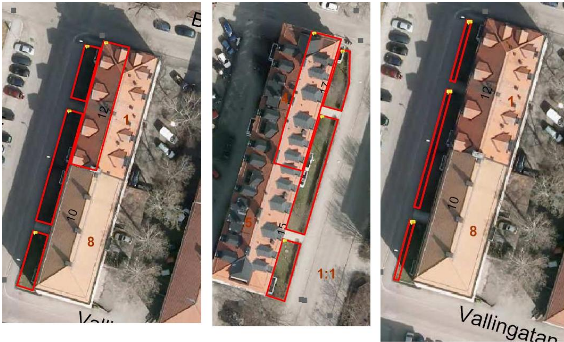
Figur 30. Till vänster och mitten: Husen längst ut mot gatan i kvarteret Gudmund. Markerade grösytor kan användas för infiltrering av dagvatten från de markerade takytorna. Till höger: Huset längst ut mot Tessingatan. Markerade ytor kan användas som biobäddar (bilder från Mälarenergi 2013).
