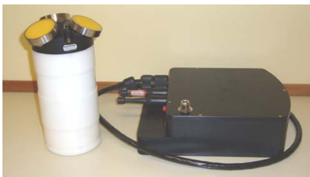
Figur 5. ADCP:n (t.v.) och enheten för strömförsörjning, GPS-inkoppling samt utskickning av signaler (t.h.) Foto Emma Andersson.
