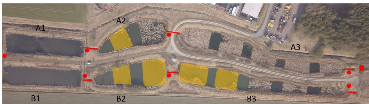
Figur 10. Flygbild över Örsundsbro våtmark. Brunnar visas som röda prickar, rännor som röda sträck och utloppsstationen som röd fyrkant. Bilden är tagen 2019-04-25 i samband med åtgärdsutredningen som gjordes. Vid tillfället saknades vegetationen i delar av dammarna, gulmarkerade område. Ingen mer åtgärd har gjorts och utbredningen av växtlighet ser ungefär ut densamma idag som då. Bild hämtad och används med tillstånd från Enköpings kommun (2019).
