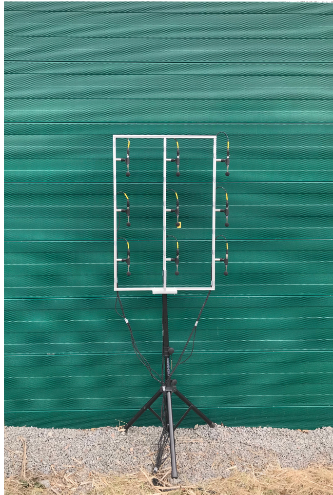
Figur E1: Metallrutnätet med de nio mikrofonerna monterad framför bullerskyddsskärmen i Knivsta.
