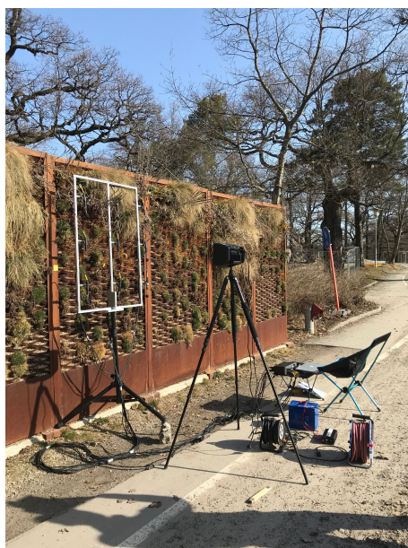
Figur 8: Mätupställningen framför ett av elementen hos bullerskyddsskärmen intill Lidingövägen.
