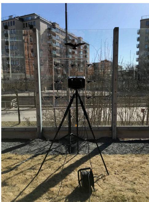
Figur 10: Det uppmätta elementen hos bullerskyddsskärmen vid Fridhemsplan, med högtalaren och metallrutnätet med mikrofonerna monterade på sina positioner framför skärmen.
