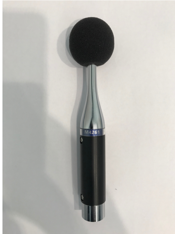
Figur E2: En av mikrofonerna, där samtliga var av modellen NTI Audio M4261.
