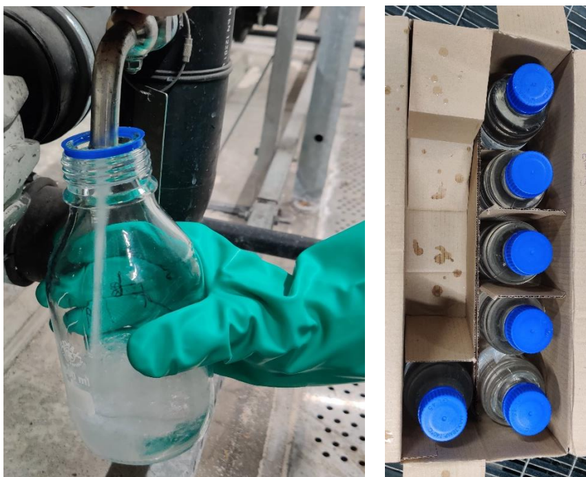
Figur B2. Till vänster visas hur en provtagningsflaska fylls med rökgaskondensat mellan 2 + - och As-kolonnen. Till höger syns alla sex flaskorna fyllda med kondensat från de sex olika provpunkterna på ENA.
