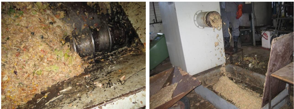
Figur 2. Malning av matavfall från skolkök i kvarnen PALMIA. Till vänster obehandlat matavfall i mottagningstratten, till höger malt material. Foto: Emelie Ljung
