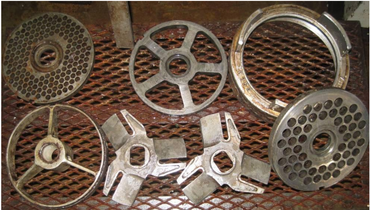
Figur 1. Kvarndelar som användes vid malning av matavfall i PAMLIA-kvarnen. På övre raden från vänster syns en 10 mm hålskiva, 5-ekrad hålskiva och yttersta lagringen som håller alla delar på plats. Nedre raden från vänster syns den första lagringen, två 3-bladiga knivar och slutligen en 16 mm hålskiva. Foto: Emelie Ljung
