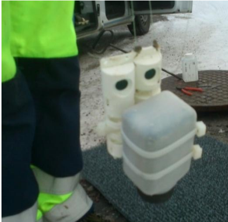
Figur 12. Två Ecoscope med tyngd upphängda i fiskelina. Jonbytarmassan är placerad på toppen av Ecoscopen i de två mörka cirkelarna som syns i bilden. Tyngden är plastbehållaren som är fäst framför Ecoscopen (författarens bild).
