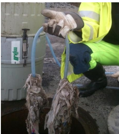
Figur 10. Provtagningssilen vid brunn S5. Provtagnings silen var vid flera tillfällen täckt av trasor och hushållpapper, speciellt vid denna brunn. Till vänster står ISCO provtagaren (författarens bild).
