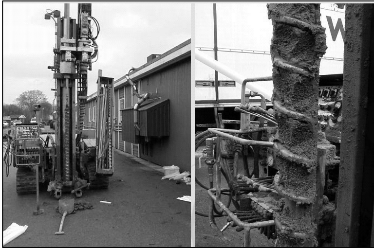
Figur 13. Jordskrubborrning med börbandvagn
