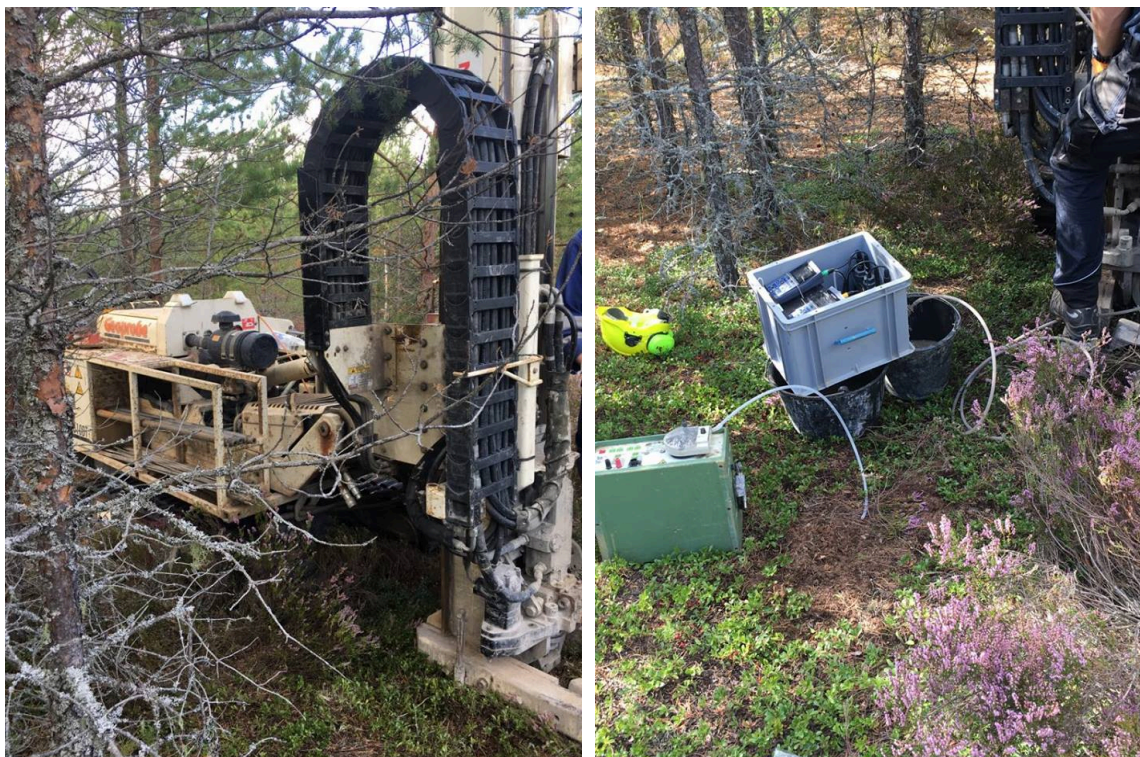
Figur 6. Geoopbeurustning som användes vid dynamiska grundvattenprovtagning (till vänster) och uppställning för dynamisk grundvattenprovtagning på höjdryggen (till höger).
