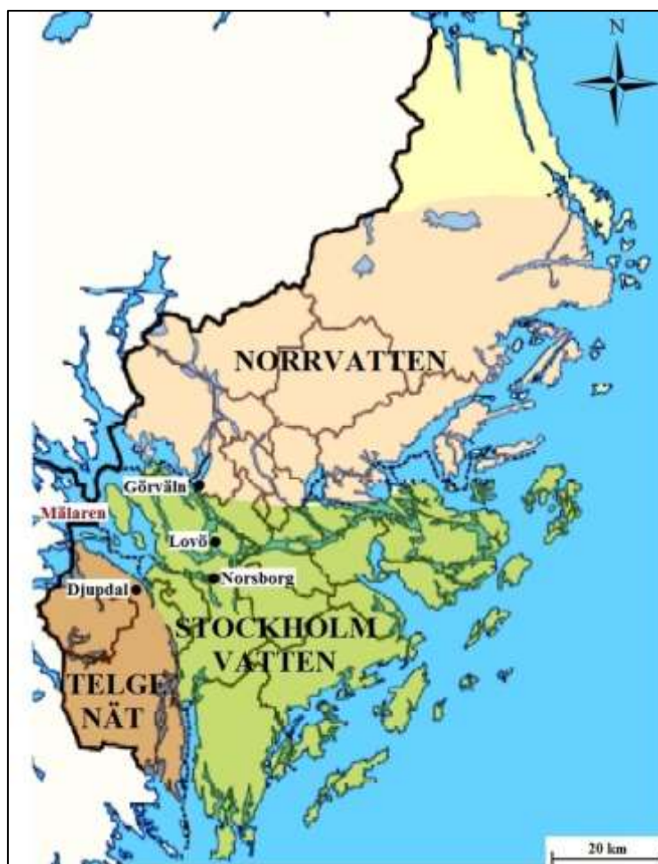
Figur 2 Ungefärlig indelning av distributionsområdena hos Stockholms läns tre stora dricksvattenproducenter. Figuren visar även lokaliseringen av de fyra stora dricksvattenverken (bakgrundskarta från Eniro, 2014).
