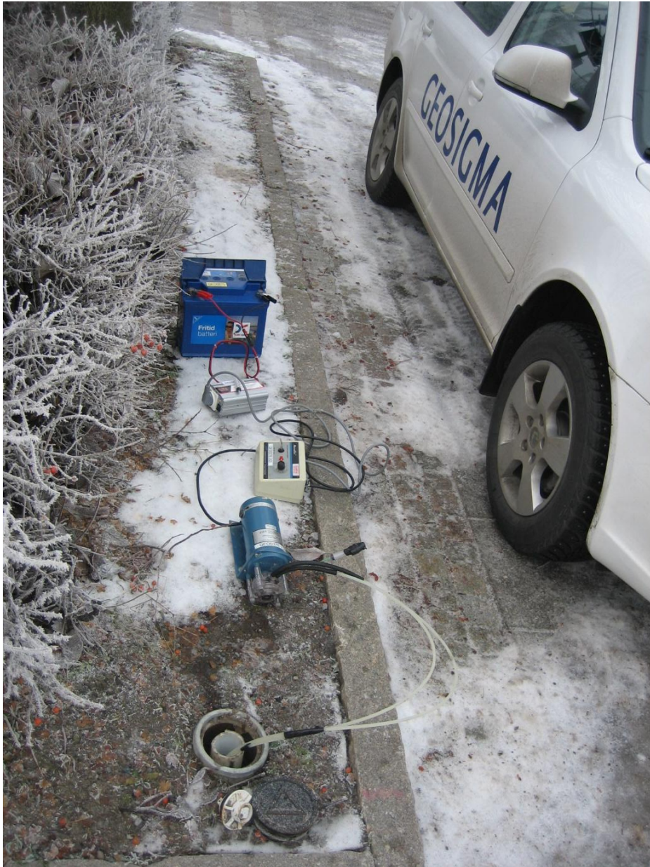
Figur 6-4 Mätuppställning för utspädningsmätning.
