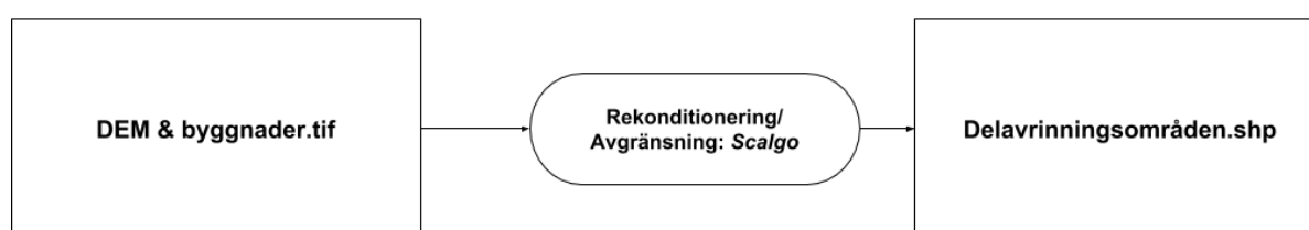
Figur 13 Metod för framtagande av delavrinningsområden enligt metod IV. Programmet Scalgo användes för att baserat på höjddata och förhöjda byggnader ta fram delavrinningsområden inom modellområdet.
