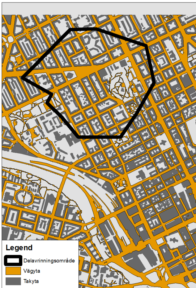
Figur 18 Tak- och vägyta användes för att beräkna delavrinningsområdenas bidragande yta. Bilden är exemplifierande och området har inte ingått i studien.
