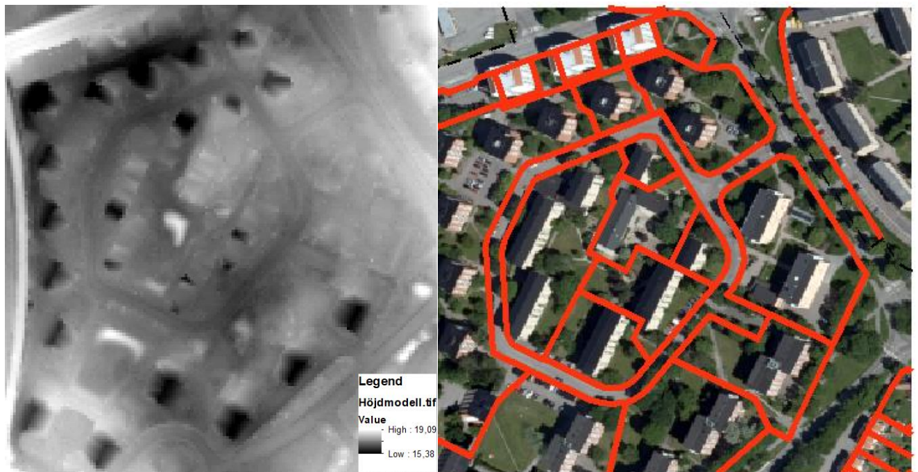
Figur 8 Höjddata (t.v.) från vilket delavrinningsområden över icke bebyggd mark togs fram, baserad på laserdata från Lantmäteriet: Höjddata 2m Raster © Lantmäteriet. Fastighetsgränser (t.h., röda linjer) i kvartersmark från Fastighetskartan © Lantmäteriet. Bakgrundsfoto: GSD-Ortofoto, 1m färg © Lantmäteriet. Bilderna visar samma kvarter som inte ingått i studien, men med något olika utsträckning.
