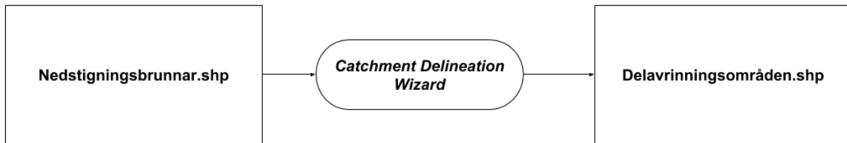
Figur 14 Flödesschema för framtagande av delavrinningsområden enligt metod V. Thiessenpolygoner baserat på nedstigningsbrunnar användes för att ta fram delavrinningsområden inom modellområdet.
