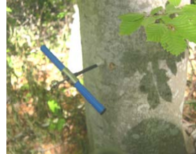
Figur 9 Trädprovtagning med tillväxtborr i juni
