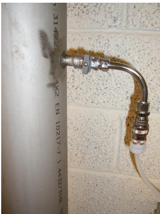
Figur 13. Provtagning från tryckledning med uppumpat vatten vid syresättningsförsök för bestämning av vattnets tangentiella partikelhastighet.
