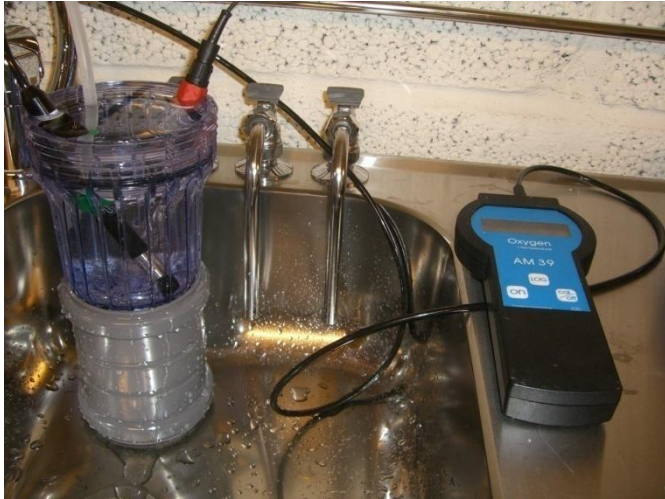
Figur 14. Försöksuppställning vid syresättningsförsök för bestämning av vattnets tangentiella partikelhastighet.
