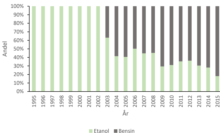
Figur 10: Andelar av energi i procent av de fossila och biobaserade komponenterna inom bränsleteknologin etanol/bensin (E85) mellan åren 1995–2015. De grå och de gröna staplarna representerar de fossila respektive de biobaserade komponenterna. Fördelningen baserar sig på Trafikverkets beräkningar. Källa: Johansson (2019).
