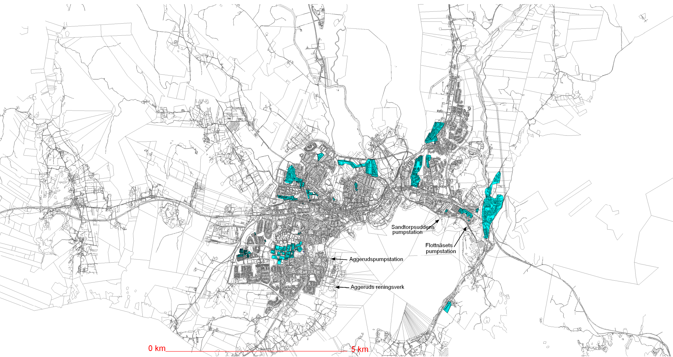
Figur 3. Områden som påverkas av driftstörningar på avloppsledningsnätet i Karlskoga. Copyright © Samhällsbyggnadsförvaltningen Karlskoga kommun
