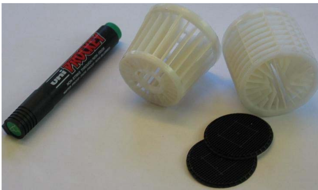
Figur 12. Bärmaterial för nitrifikation (nederst) och denitrifikation (överst).
