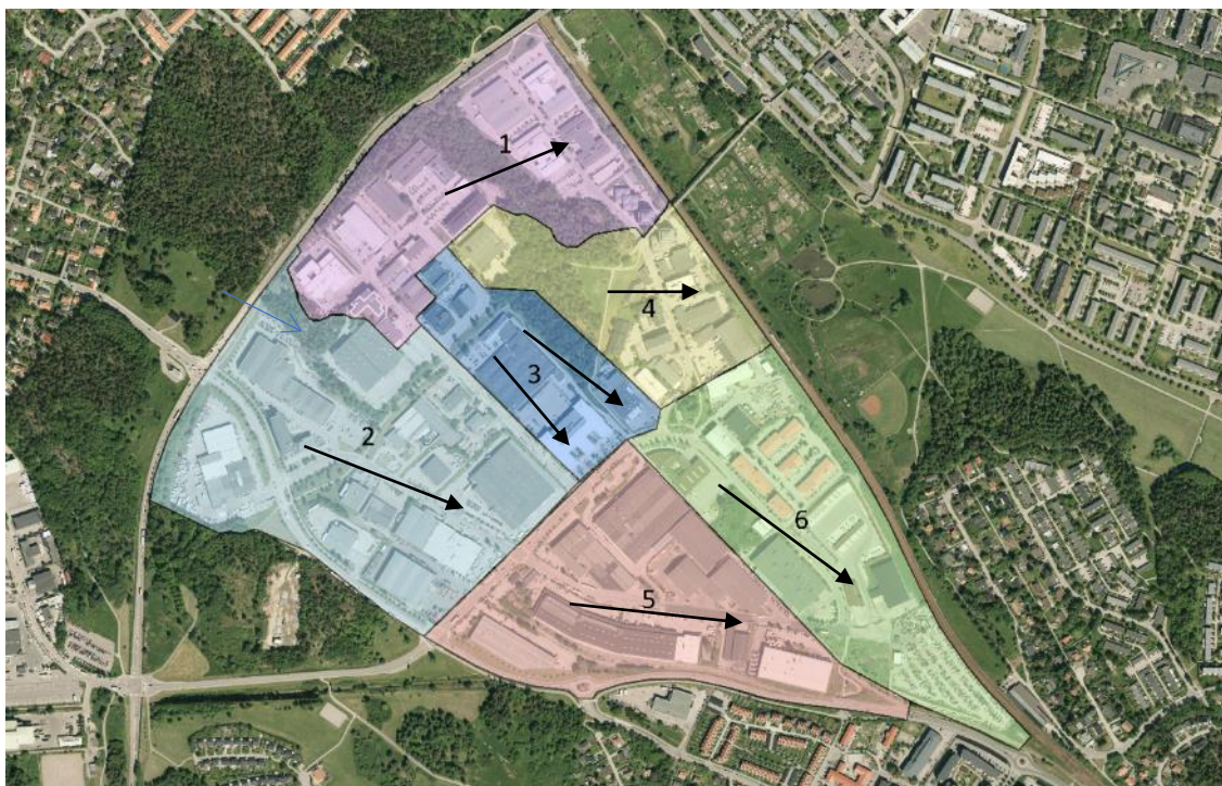
Figur 10. Delområden inom Lunda som har använts vid beräkningar och modelleringar. Svarta pilar visar troliga flödesvägar inom varje delområde utifrån höjddata och vägnät.
